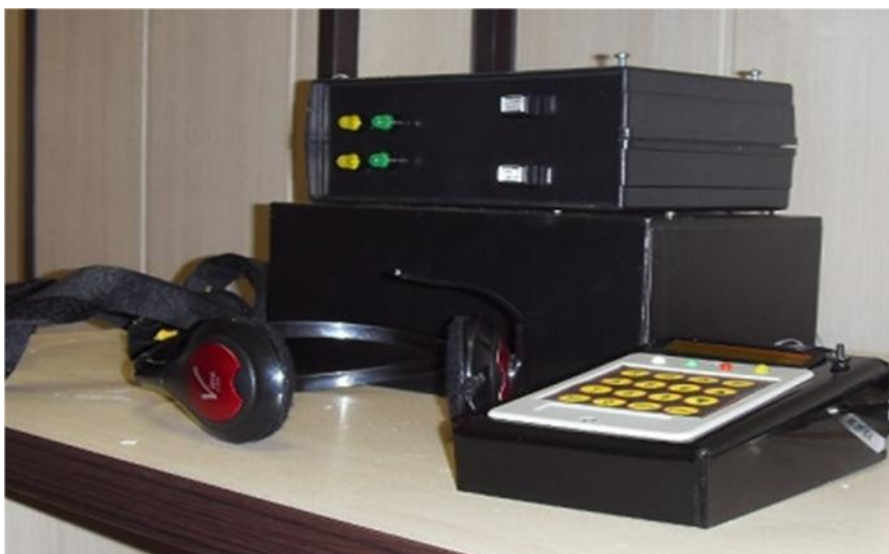
شکل ۱- دستگاه محقق ساخته بیوفیدبک (تنفسی) خانگی
