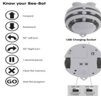
شکل ۱ - ربات زنبور (Bee bot) و اجزاء آن
