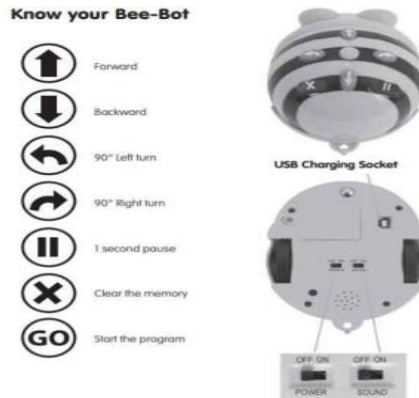
شکل ۱ - ربات زنبور (Bee bot) و اجزاء آن
