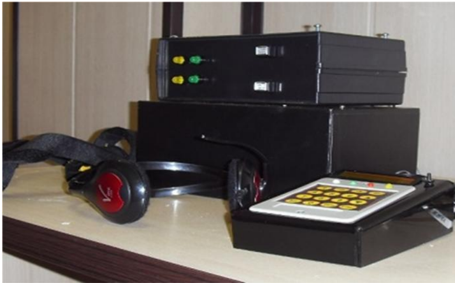
شکل ۱- دستگاه محقق ساخته بیوفیدبک (تنفسی) خانگی
