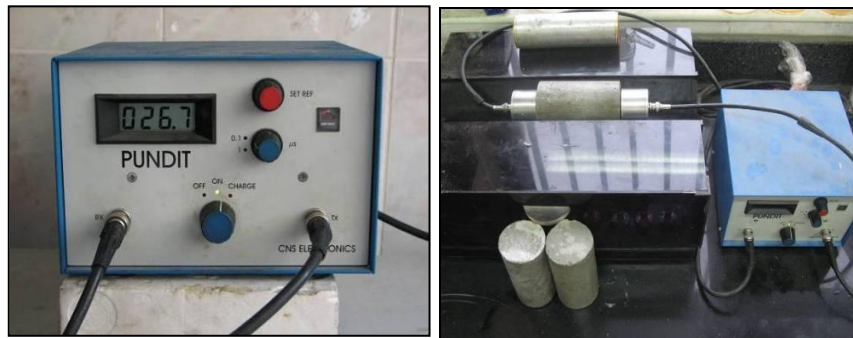
شکل ۳. تعیین سرعت موج فشاری بر روی مغزه‌ها
