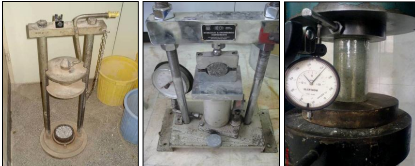
شکل ۱. انجام آزمایش مقاومت فشاری، برزیلی و ارزش ضربه‌ای سنگدانه‌ها
