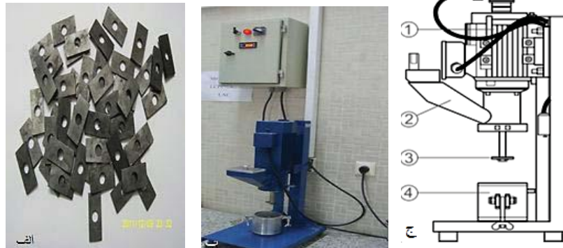
شکل ۵. مجموعه تجهیزات آزمایش LCPC با پروانه آن [۱۰]
