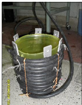
شکل ۳. سیم پیچ ایجاد شده برای تولید جریان الکترومغناطیس
