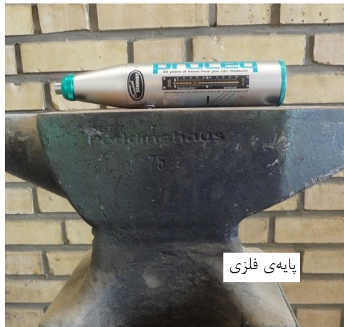
شکل ۲. چکش اشمیت به‌همراه پایه فلزی سنگین
