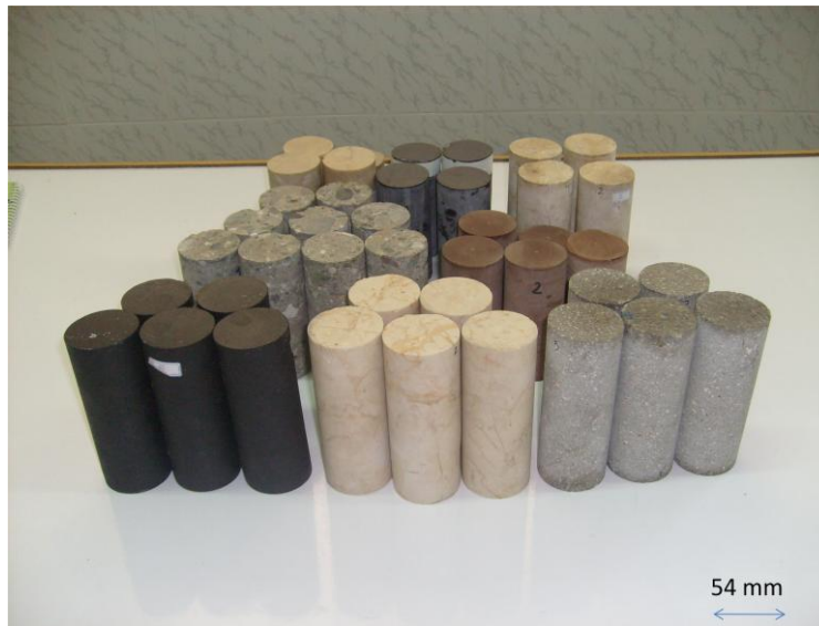
شکل ۶. مغزه‌های استوانه‌ای آماده‌سازی شده برای آزمایش اولتراسونیک
