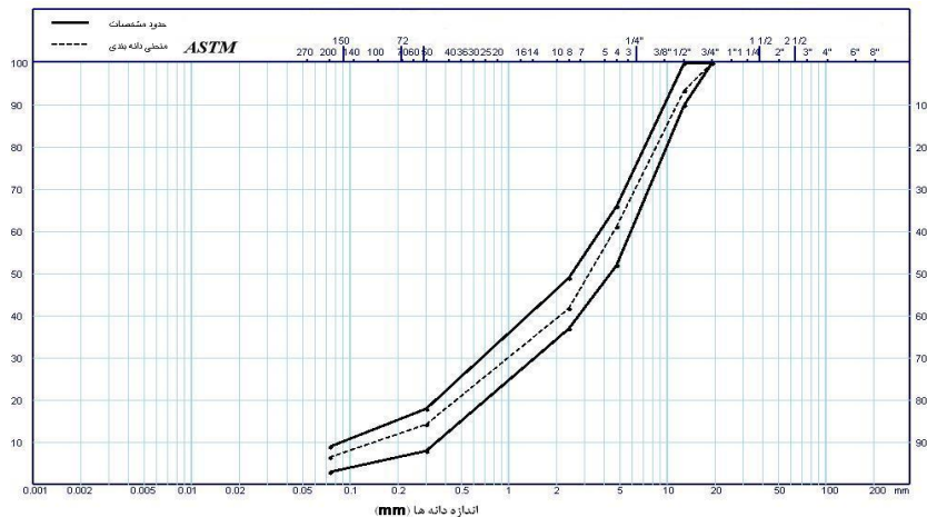
نمودار ۴: دانه‌بندی مخلوط مصالح سنگی طرح اختلاط آسفالت
