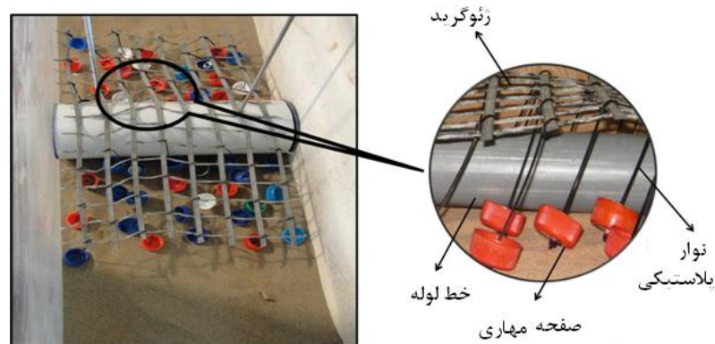
شکل ۲. استفاده از سیستم مهار- شبکه در آزمایشگاه
