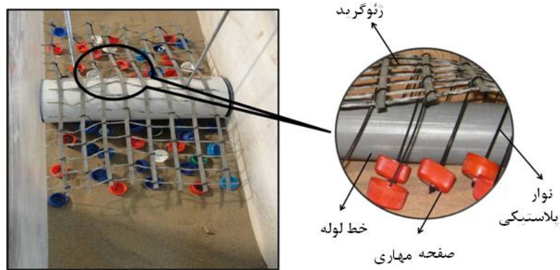
شکل ۲. استفاده از سیستم مهار- شبکه در آزمایشگاه
