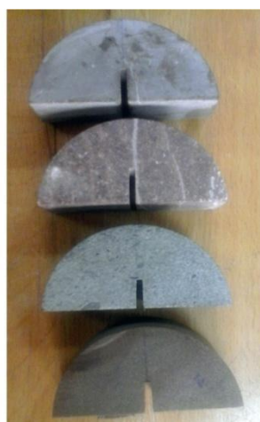
شکل ۱. نمونه‌ها قبل از آزمایش برای ۴ نوع سنگ (از بالا به پایین سنگ آهک، آندزیت، توف سبز و ماسه سنگ)
