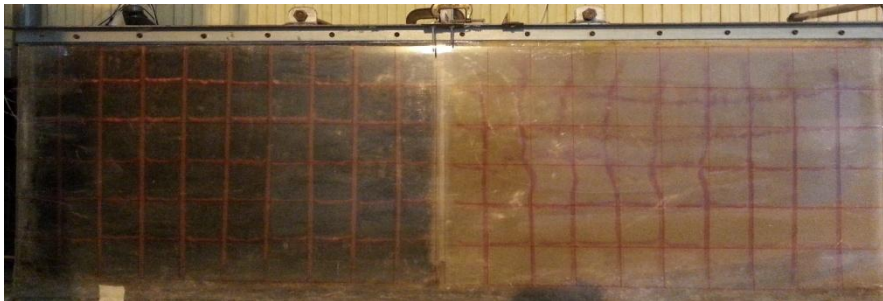
شکل ۱۱. تغییر شکل مدل بعد از بارگذاری برای تست d TC_r = 20\%
