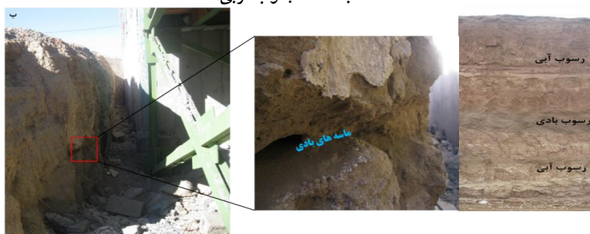
شکل ۳. توالی رسوبات بادی و آبی، الف) خیابان وصال (دید به سمت شرق)، ب) خیابان هلال احمر (دید به سمت شمال‌غربی)
