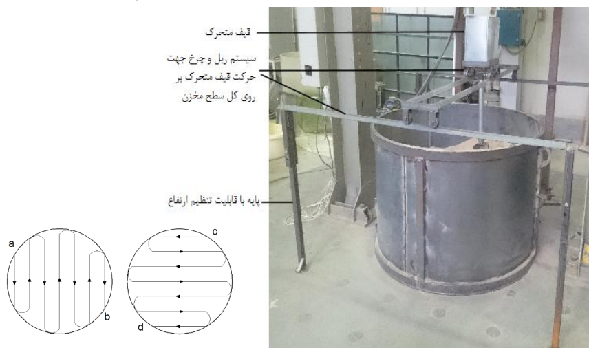
الف ب شکل ۵. الف) نمایی از سیستم هدایت قیف بر کل سطح مخزن ب) مسیر حرکت
