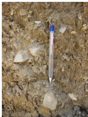
شکل ۶. دانه‌های درشت گردگوشه در رس آبرفتی
