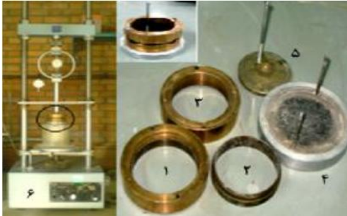
شکل ۱. قالب تراکم استفاده شده برای ساخت نمونه‌ها
