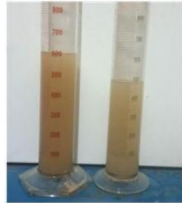
دبی خروجی خاک منطقه بق قجه بالا یا دانسته حداکثر (راست) و دانسته طبیعی (چپ)
