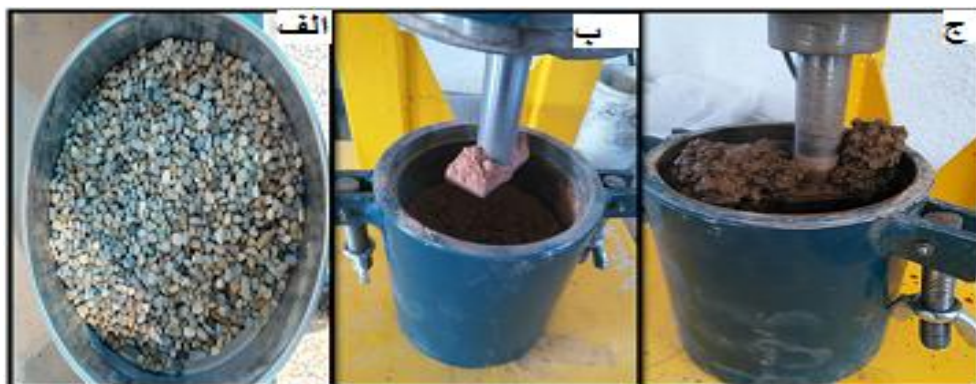
شکل ۲. انجام آزمایش LCPC (الف) نمونه خاک قبل از آزمایش، (ب) ایمپلر قبل از انجام آزمایش، (ج) نحوه ریختن نمونه‌ها به داخل دستگاه، (د) نمونه بعد از انجام آزمایش، (ه) ایمپلر بعد از انجام آزمایش
