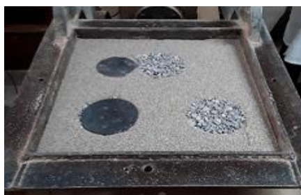
شکل ۱۱. آرایش قرارگیری ستون‌های سنگی در آرایش مثلثی الف) ۸/۴، ب) ۱۲/۴، ج) ۱۶/۴، د) نمونه ساخته شده در دستگاه برش مستقیم
