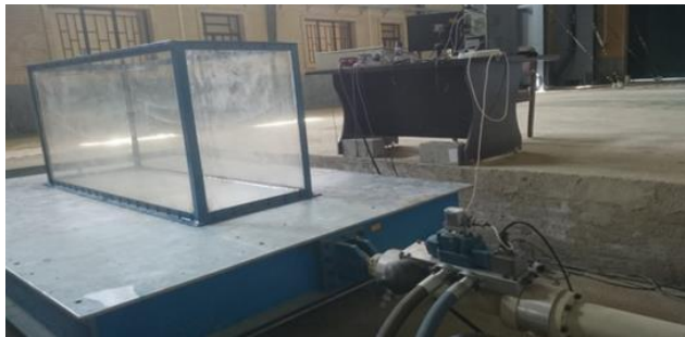
شکل ۱. محفظه مدل روی میز لرزه
