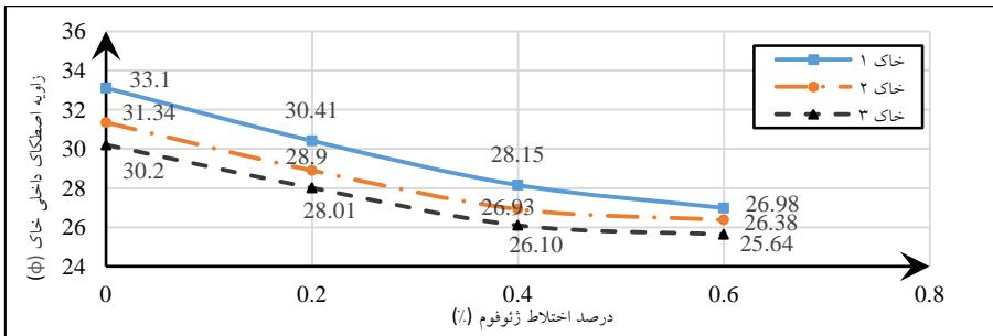
شکل ۹. نمودار زاویه اصطکاک داخلی بر حسب درصد اختلاط ژئوفوم برای خاک‌های آزمایش شده
