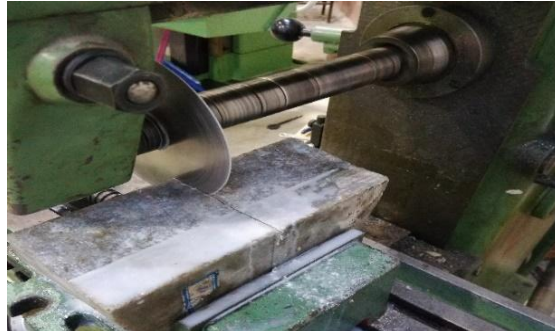
شکل ۳. نحوه ایجاد ترک در قطعات نیم‌دیسک
