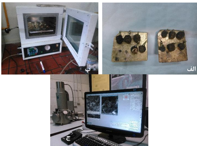
شکل ۳. تصاویری از نحوه آماده‌سازی و انجام عکس‌برداری میکروسکوپی SEM: الف) پوشش طلا، ب) اون خلأ، ج) تفنگ الکترونی و نمایش‌گر تصاویر
