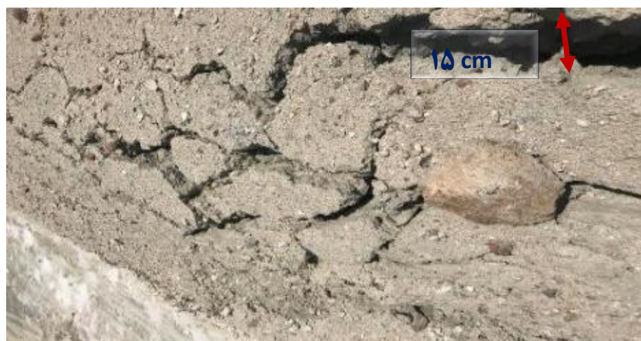
شکل ۱۷- نمونه درزه کششی در سنگ‌های شیستی معدن چاه خاتون
