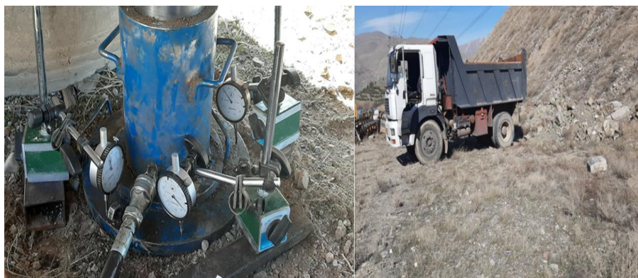
شکل ۳- محل استقرار کامیون برای اعمال بار و آماده سازی محل قرار گیری سه عدد گیج اندازه گیری نشست
