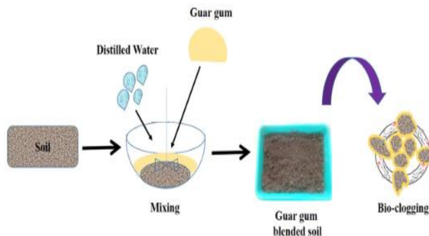
شکل ۲. فرآیند چرخه زندگی یک خاک عمل‌آوری شده با صمغ گوار (Gresta et al., 2014) Fig 2. Life cycle process of a soil treated with guar gum
