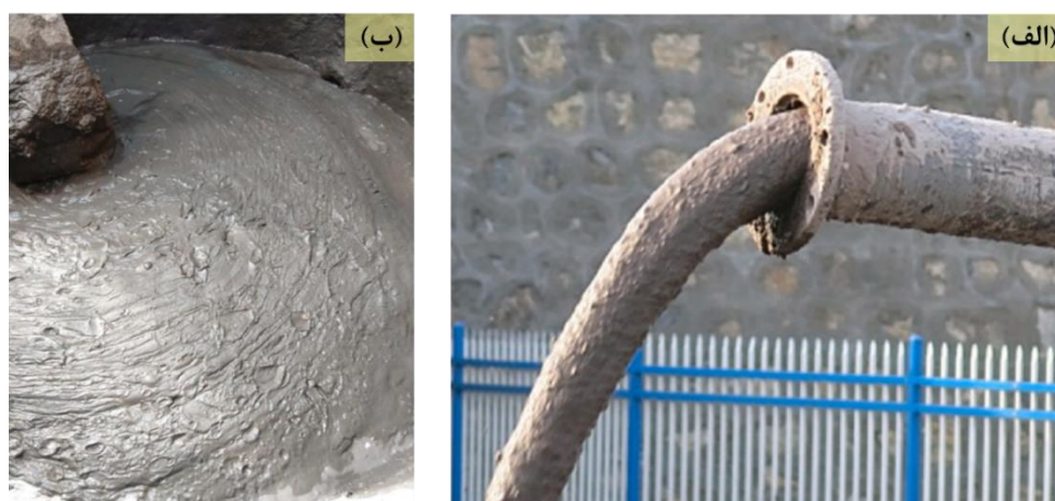
شکل ۲. (الف) جریان (Dong et al., 2023) و (ب) بافت پرکننده خمیری (Behera et al., 2021)
