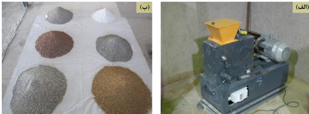
شکل ۱۷. (الف) سنگ‌شکن فکی مورد استفاده و (ب) سنگدانه‌های حاصل از خردایش نخاله
