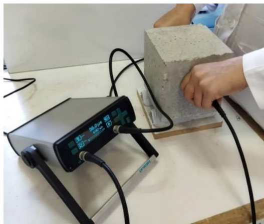
شکل ۱۰. نمایی از نحوه تعیین سرعت موج با دستگاه اولتراسونیک بتن
