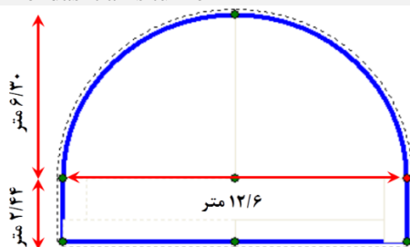
شکل ۷. مقطع تونل محور پاتاوه-دهدشت در محیط مورد مطالعه
