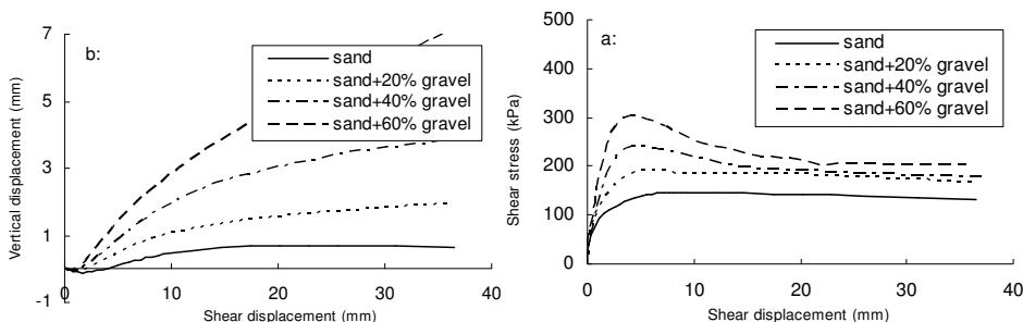
شکل ۴. تغییرات (a) تنفس برشی و (b) تغییر مکان قائم با تغییر مکان برشی همچنین شکل ۵ تغییرات مقاومت برشی مخلوط شن و ماسه را در دانسیتۀ نسبی ۶۰ درصد و سربارهای مختلف با درصد شن گردگوش ۲۵/۴ میلی‌متری نشان می‌دهد. بر اساس این
