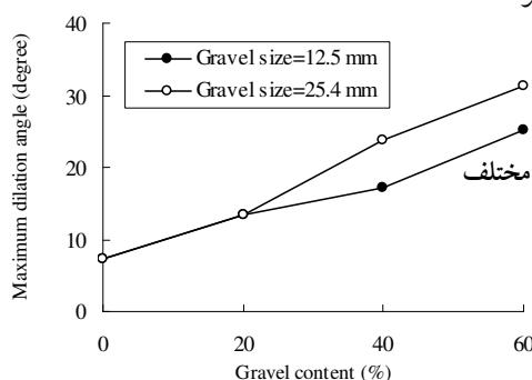
شکل ۱۱. تغییرات زاویه اتساع با درصد شن‌دانه برای مخلوط حاوی شن با اندازه‌های مختلف
