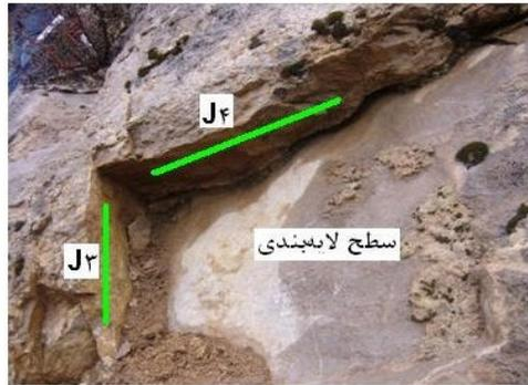
شکل ۸. سیستم درزه‌های J<sub>3</sub>، J<sub>4</sub> و لایه‌بندی
