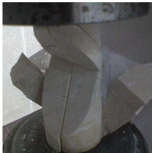
شکل ۸. شکست نمونه دارای سه دسته ناپیوستگی متقطع و عمود برهم شامل یک دسته قائم دارای زاویه  $90^\circ$  درجه، دو دسته ناپیوستگی عمود بر هم دارای زوایای  $30^\circ$  و  $60^\circ$  درجه با حالت افقی و در جهت مخالف همدیگر و ناپیوستگی با زاویه  $30^\circ$  درجه دارای ۴ ناپیوستگی موازی در آزمایش مقاومت فشاری یکمحوری
