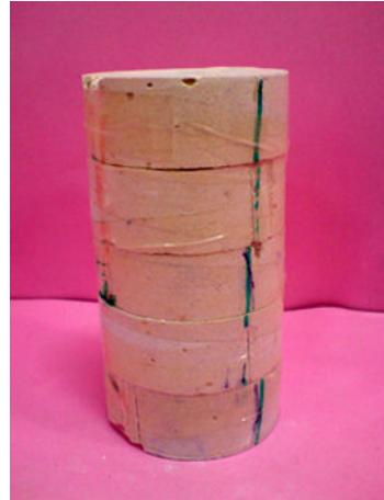
شکل ۱. دودسته ناپیوستگی قائم و عمود برهم و یک دسته در جهت افقی و دارای ۴ ناپیوستگی موازی
