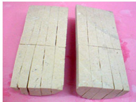
شکل ۵. نمونه دارای سه دسته ناپیوستگی متقطع و عمود برهم، یکی دسته ناپیوستگی با زاویه  $90^{\circ}$  درجه دارای ۴ ناپیوستگی موازی است و در جهت دسته قائم برای نمایش از وسط باز شده است.
