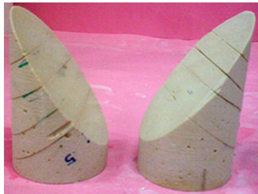
شکل ۳. نمونه دارای دو دسته ناپیوستگی عمود بر هم هر یک دارای زاویه  $45^{\circ}$  درجه و در جهت مخالف همدیگر یکی از دسته‌ها دارای ۴ ناپیوستگی موازی و نمونه آماده برای ایجاد یک دسته قائم است
