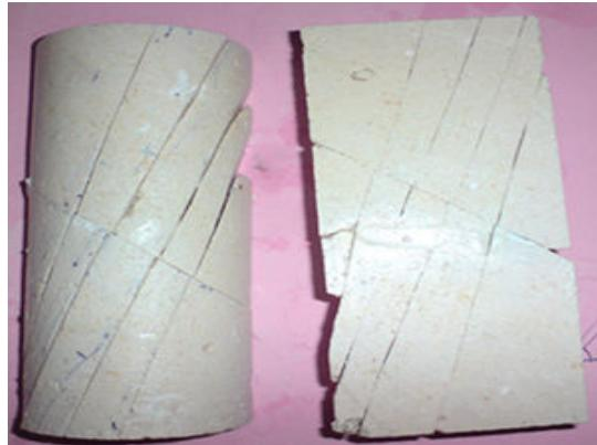
الف) نیم رخ ناپیوستگی ها در صفحه قائم در داخل نمونه ب) نیم رخ ناپیوستگی ها در جهت قائم در بیرون نمونه شکل ۴. نمونه دارای دو دسته ناپیوستگی عمود بر هم با زوایای  $30^{\circ}$  و  $60^{\circ}$  درجه و در جهت مخالف هم دیگر، دسته ناپیوستگی با زاویه  $60^{\circ}$  درجه دارای ۴ ناپیوستگی موازی و نمونه درجهت دسته قائم برای نمایش از وسط جدا شده است.
