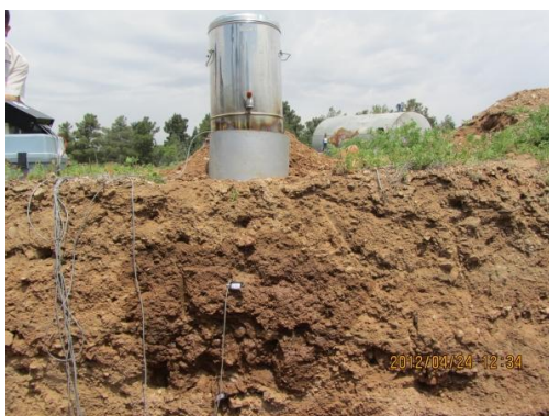
شکل ۱۰. آزمایش حرارت‌سنجی با استفاده از تزریق آب گرم ۵۰ درجه و ثبت حرارت با حس‌گر حرارتی
