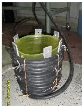
شکل ۳. سیم‌پیچ ایجاد شده برای تولید جریان الکترومغناطیس
