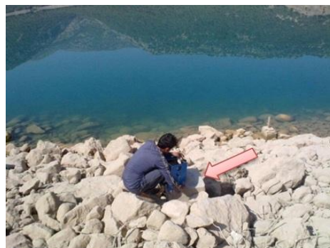
شکل ۶. فاصله پیزومتر Bx4 از سطح آب دریاچه سد
