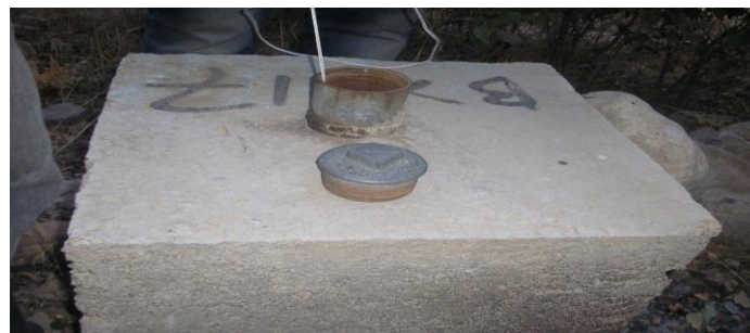
شکل ۳. تصویر کلی یک پیزومتر
