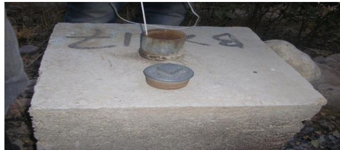
شکل ۳. تصویر کلی یک پیزومتر
