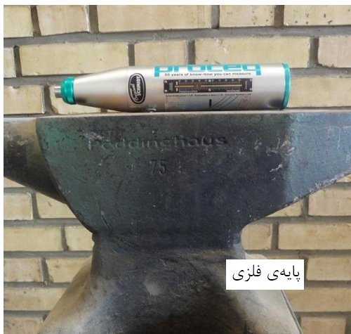
شکل ۲. چکش اشمیت به‌همراه پایه فلزی سنگین
