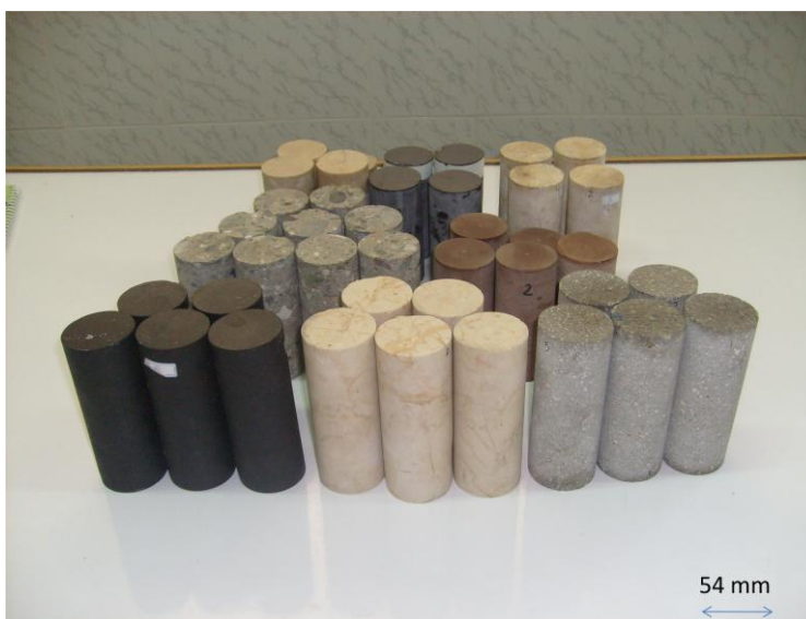
شکل ۶. مغزه‌های استوانه‌ای آماده‌سازی شده برای آزمایش اولتراسونیک
