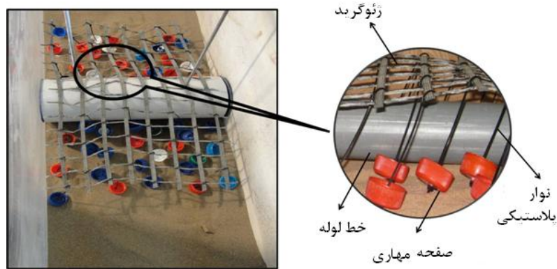
شکل ۲. استفاده از سیستم مهار- شبکه در آزمایشگاه
