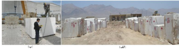
شکل ۹. الف) نمایی از بلوک‌های استخراجی تراورتن مجتمع معدنی حاجی‌آباد محلات و ب) ارزیابی آن‌ها با روش GPR
