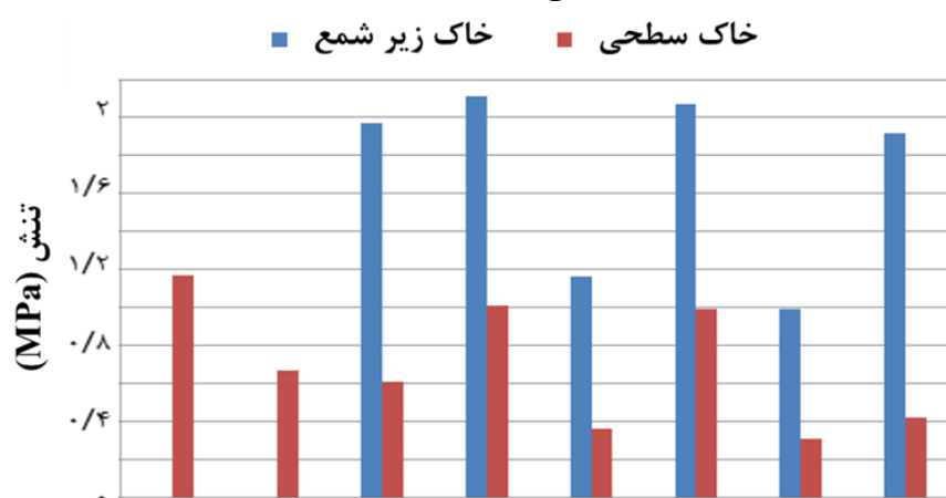
شکل ۵. تنش در خاک سطحی بلافاصله زیر دال (در بین شمع‌ها) و در خاک قرار گرفته در زیر شمع‌ها
