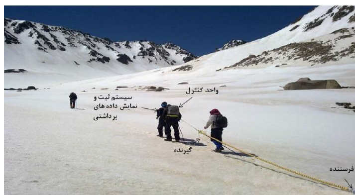
شکل ۳. تصویری از برداشت داده‌های GPR در یخچال علم‌کوه و نمایش قسمت‌های مختلف سیستم GPR (ویرایش شده از [۴۳])
