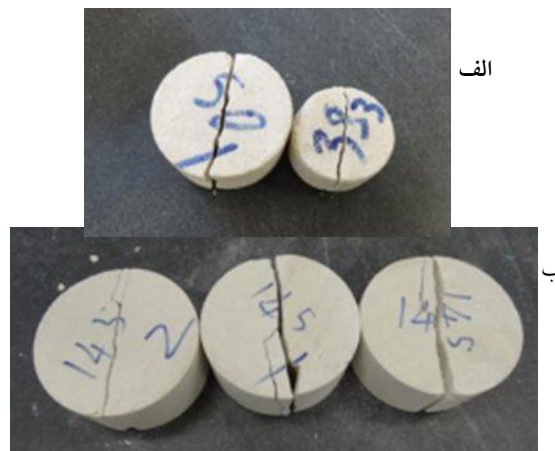
شکل ۶. بررسی مکانیسم شکست نمونه‌ها در آزمایش برزلی الف) نمونه‌های با قطر ۱۴۵ میلی‌متر و ب) دو نمونه با قطرهای ۳۸ و ۵۰ میلی‌متری
