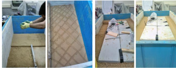
شکل ۹. خاک‌ریزی جعبه آزمایش
