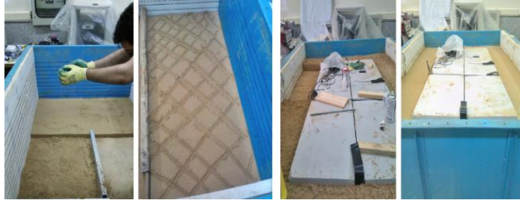
شکل ۹. خاک‌ریزی جعبه آزمایش
