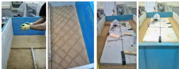
شکل ۹. خاک‌ریزی جعبه آزمایش
