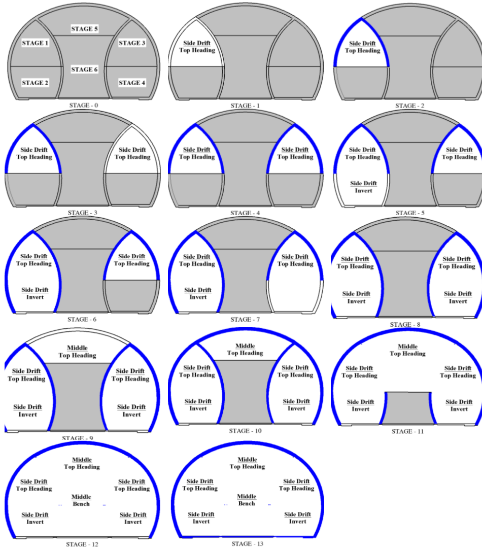
شکل ۱۳. مراحل حفاری در کلاس حفاری و نگهداری B
