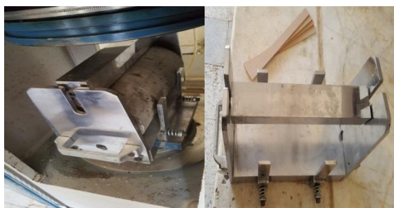
شکل ۱۰. گیره مناسب برای نمونه ۱۵۰ در ۳۰۰ میلی‌متری
