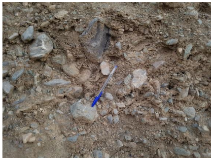
شکل ۷. دانه‌های تیزگوشه در رس برجا شکل ۸. شن و ماسه رودخانه‌ای اطراف رود قشلاق
