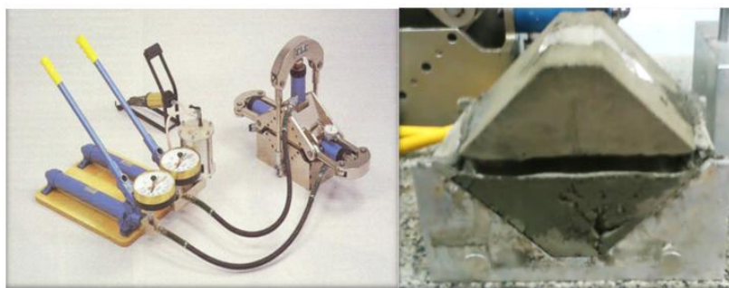
شکل ۳. آزمایش برش مستقیم روی نمونه سنگی، الف) آماده‌سازی نمونه برای آزمایش، ب) دستگاه آزمایش برش مستقیم
